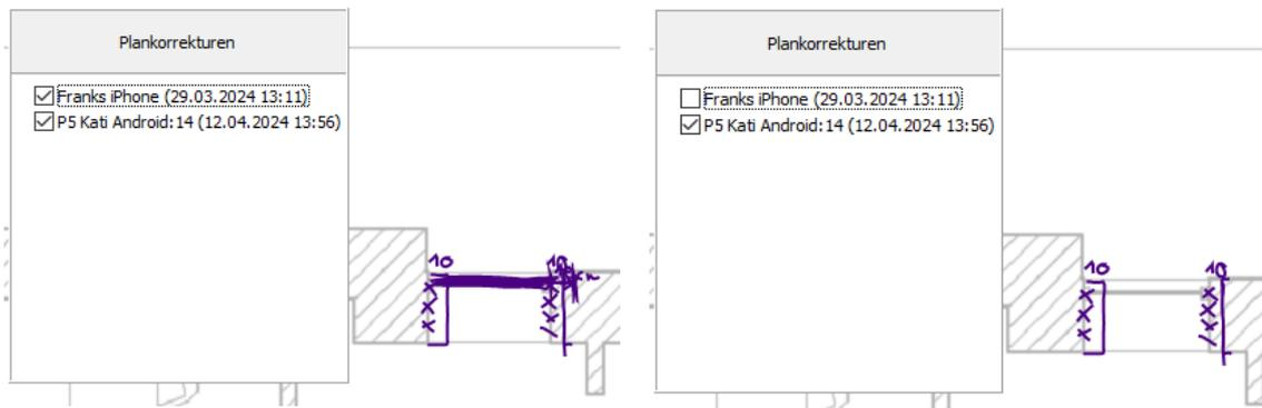
Dafür werden alle Markierungen und Bilder ausgeblendet. Falls mehrere Mitarbeiter unabhängig voneinander Korrekturen eingetragen haben, kann der technische Zeichner auswählen, welche Korrekturen von welchem Mobilgerät angezeigt werden sollen. Nachdem die Korrekturen in einen neuen Plan eingearbeitet wurden, kann der veraltete Planstand durch den neuen ersetzt werden.
